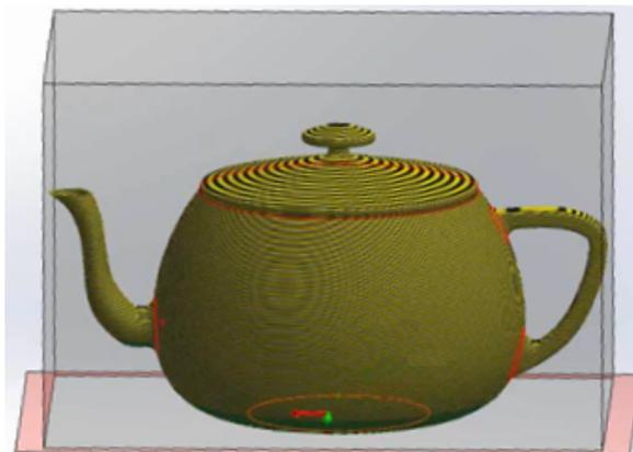
La hauteur de couche par défaut est de 0,3 mm, ce qui correspond à une résolution grossière avec une vitesse relativement rapide de l'imprimante.
