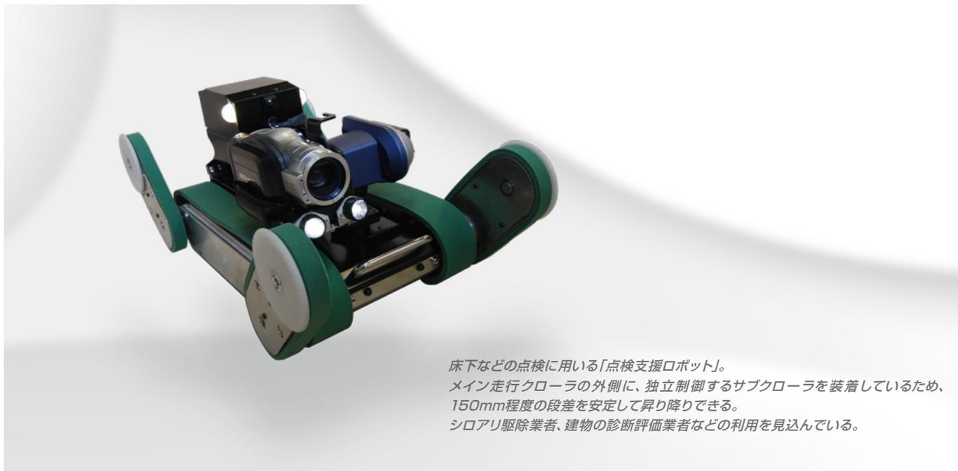
床下などの点検に用いる「点検支援ロボット」。
