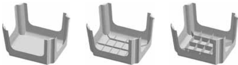
Imagen 5: estructuras de refuerzo propuestas para obtener más resistencia
