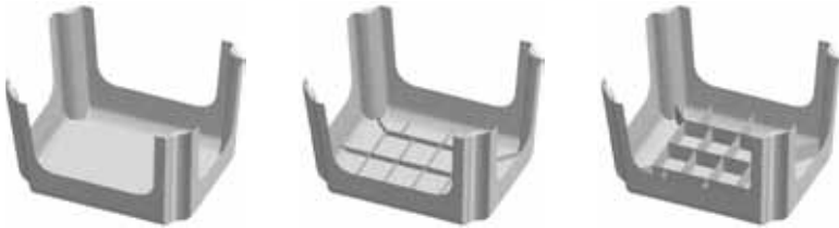
Abbildung 5: Entwurfsvarianten mit Versteifungslamellen
