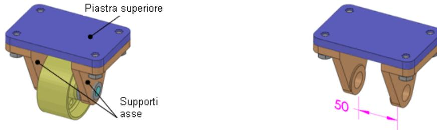
L'assieme contiene sostegni d'asse fissati alla piastra superiore mediante bulloni di 10 mm. La misura da valutare è la distanza minima e massima tra le facce interne dei sostegni d'asse.
