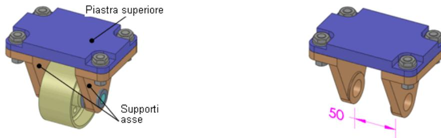
L'assieme contiene sostegni d'asse fissati alla piastra superiore mediante bulloni di 10 mm.
