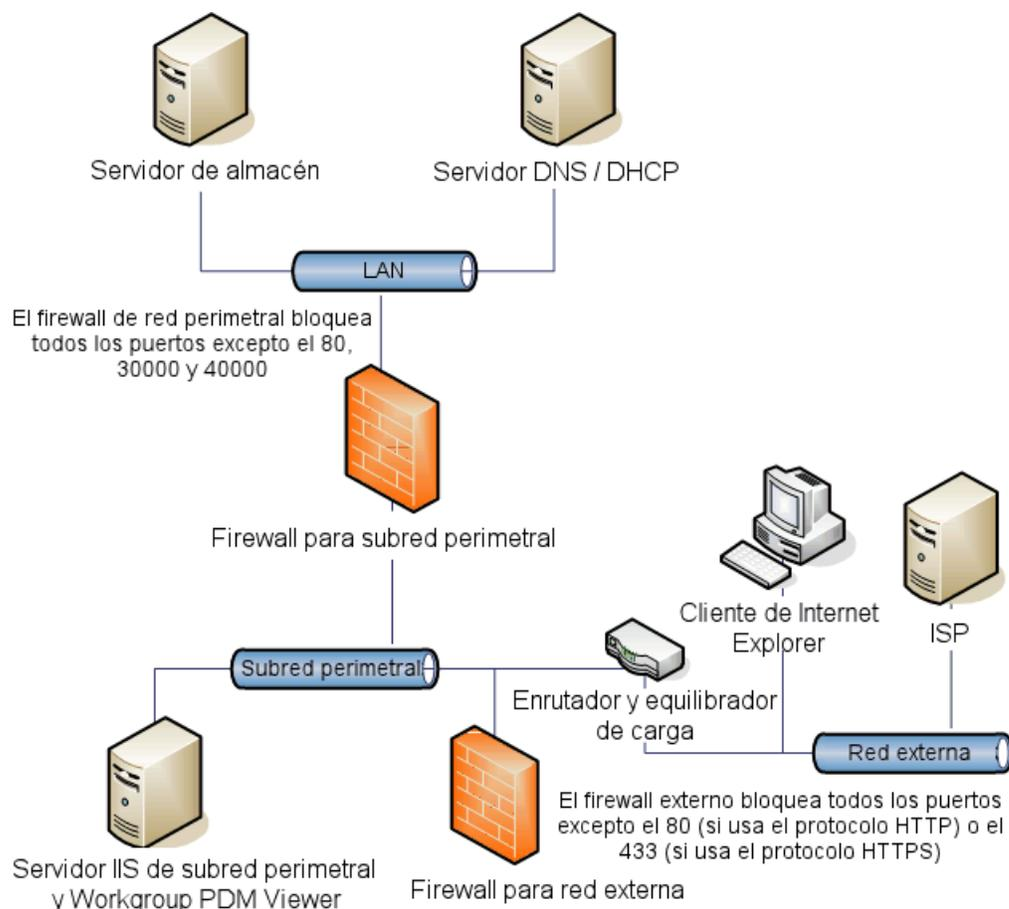
El cliente de Internet Explorer se conecta al servidor de Workgroup PDM Viewer/IIS mediante el puerto 80 (o 443 si está configurado para utilizar SSL). A continuación, Workgroup PDM Viewer se conecta al servidor del almacén a través de los puertos 30000 o 40000. Éste envía la información solicitada a Workgroup PDM Viewer, que a su vez se la suministra al cliente de Internet Explorer.
