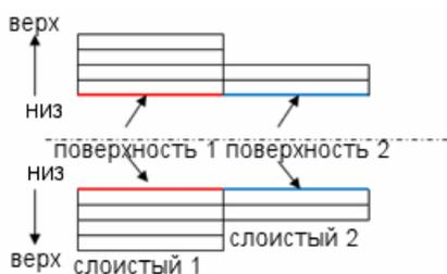
Создадим две поверхности, используя внутренний радиус вала, и выберем параметр **Нижняя поверхность**. Этот шаг исключает необходимость переопределения геометрии при каждом изменении количества слоев или толщины слоистых конструкций.
