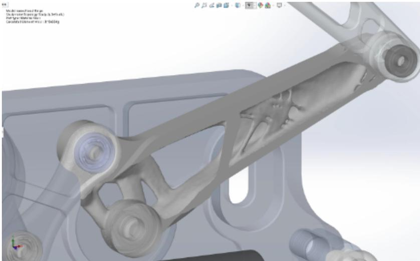
Um die Vernetzung der optimierten Geometrie als neue Geometrie zu speichern, klicken Sie mit der rechten Maustaste auf die Darstellung der **Materialmasse** und klicken Sie dann auf **Geglättetes Netz exportieren**. Sie können die Netzdaten in einer neuen Konfiguration oder in einer neuen Teiledatei speichern.
