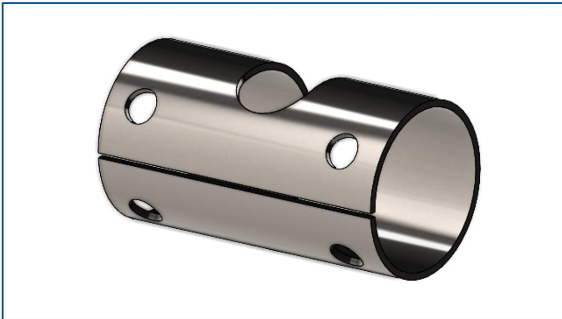
Vous pouvez utiliser l'outil de **découpe** pour créer des découpes dans des corps cylindriques et coniques creux ou à parois minces. En sélectionnant une arête sur une face cylindrique ou conique, vous pouvez mettre la pièce à plat en tant que tôlerie.
