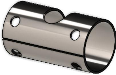
Una volta completata la lacerazione, è possibile convertire la parte in lamiera utilizzando lo strumento **Inserisci piegature**
