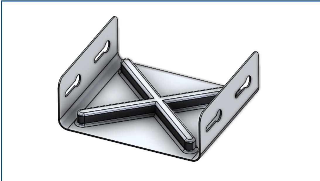
È possibile utilizzare lo strumento **Timbro** per creare strumenti di formatura parametrica basati su schizzo da applicare alle parti in lamiera. Con gli strumenti di formatura basati su schizzo, è possibile creare uno schizzo con parametri per il timbro o la formatura della lamiera.
