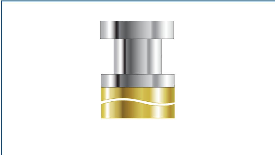
È possibile definire i tipi di gambo (**Dritto**, **Conico** o **Collo**) per qualsiasi fresa.
