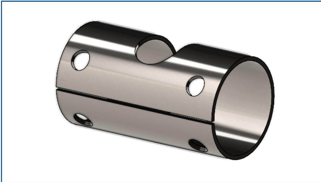
È possibile utilizzare lo strumento **Lacerazione** per creare lacerazioni nei corpi cilindrici e conici a parete sottile o cava. Selezionando un bordo su una faccia cilindrica o conica, è possibile appiattare la parte come lamiera.
