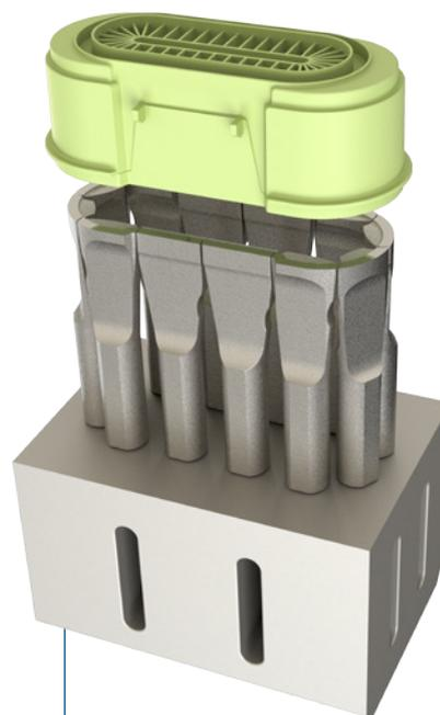
Die Ultraschall-Schweißgeräte von TELSONIC nutzen zum Verschweißen zweier Teile Vibrationsschwingungen, die eine intramolekulare Reibungshitze erzeugen. Die Ingenieure des Unternehmens vertrauen auf die SOLIDWORKS Simulation Professional Software, um schnelle Modalanalysen durchzuführen und Frequenzmodi mit einem hohen Genauigkeitsgrad vorherzusagen, damit diese den Prozess unterstützen.
