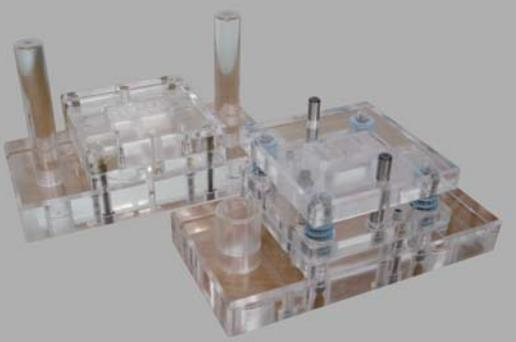
地元企業の全面的な協力により、名刺ケースの金型実物を採寸させてもらい、同校で複製を作り上げた金型試作。機械科では、2009年度から、3年生の課題研究で、金型製作をカリキュラムに取り入れている。
